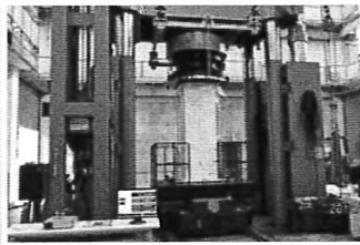
實尺寸短柱力學實驗
