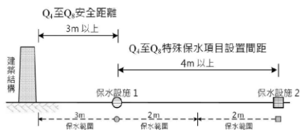
圖 9 基地保水設施與建物結構安全距離與保水設施設置間距示意圖
