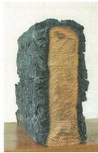
圖9.3-9 木材燃燒炭化深度示意圖
